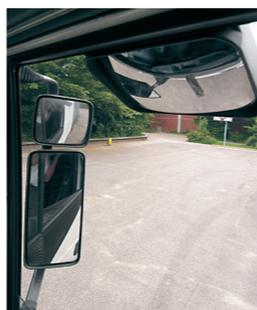
Dazwischen befindet sich jedoch eine geometrische Fläche in der Form eines spitzen Winkels von etwa 30 Grad. Alles, was sich in diesem Raum befindet, kann vom Fahrer nicht gesehen werden, wenn an seinem Fahrzeug keine zusätzlichen Hilfsmittel (wie zum Beispiel Extra-Spiegel) angebracht sind.
